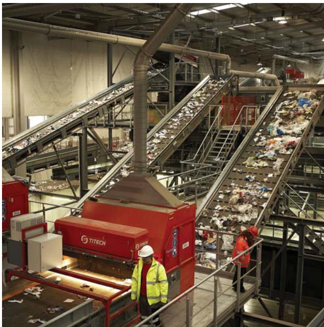
Mae'r diwydiant gwastraff yn dweud y gall cyfleusterau adfer deunyddiau modern ddarparu adnoddau ailgylchadwy o safon. Mae'r llun yn dangos y cyfleuster adfer deunyddiau a weithredir gan Biffa Waste Services yn Trafford Park, Manceinion, sy'n prosesu plastig, alwminiwm, dur, papur a cherdyn.
